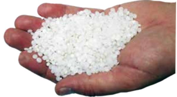
Beide Formeln wurden so entwickelt, dass sie Heißkanalsysteme mit einer Mindestgröße von 0,254 mm oder 254 µm (Mikron) durchlaufen können, um den gesamten Durchflussweg vollständig zu reinigen. Es ist keine Einweichzeit erforderlich und die Wärme muss nicht über die normalen Verarbeitungstemperaturen erhöht werden.
