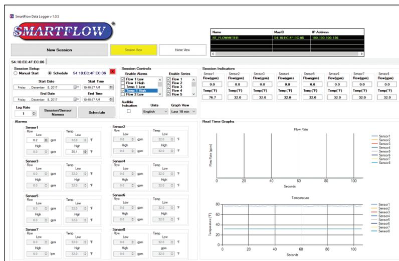
Die PC-basierte **Smartflow** Data Logger-Software bietet Temperatur- und Durchflussprozessdaten, die in Datenbanksoftware als Referenz und zur Analyse verwendet werden können. Diese Datensätze sind für Spritzgießmaschinen nützlich, die Konformität mit Vorschriften und Qualitätskontrollen bewahren müssen.
